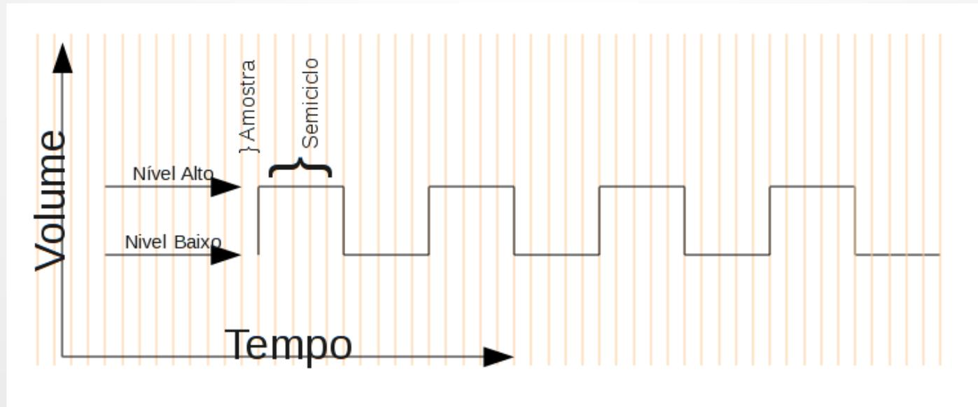
Discretização é o processo de transformar um sinal analógico em um equivalente aproximado digital.
